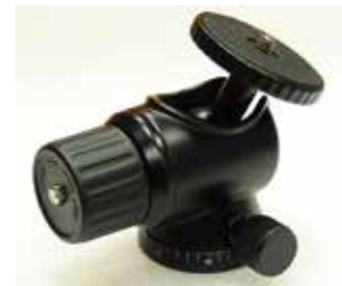
Modifizierte Kugelköpfe Diese beiden Produkte sind modifizierte Kugelköpfe, welche mittels einer überdimensionierten Griffschraube festgezogen werden können. Ein Sondermerkmal des MBH-6 und MBH-9 ist, dass durch eine zusätzliche Stellschraube auch die Klemmstärke im Lockerzustand einstellbar ist. Der MBH-9 hat eine Schnellwechselkupplung, welche mit einem durchdruchsgesicherten Schienensystem ausgestattet ist. Der MBH-6 ist einfacher gebaut, mit seinen 8,2 cm auch ein wenig kleiner, hier ist die Plattform fix und man kann die Kamera direkt darauf schrauben. Tragfähigkeit: 9kg bzw. 6kg. MBH-9 MBH-6 WECHSELPLATTE
